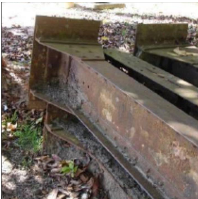
Figura 2.3 – Perfis metálicos, em contato direto com a umidade e com os minerais do solo, sujeita à corrosão eletroquímica.
