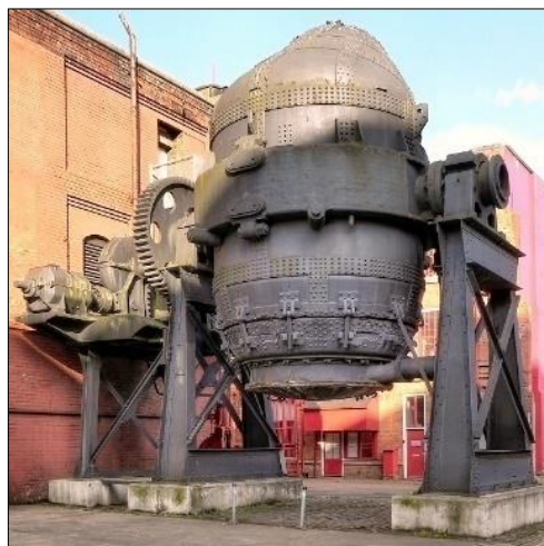
Figura 3.5 – Fotografia de um conversor Bessemer de fins do século XIX, hoje apresentado como peça no Kelham Island Museum, na cidade de Sheffield, Yorkshire, Inglaterra.
